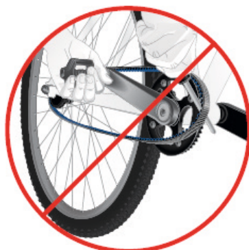
mit Hebel aufziehen
